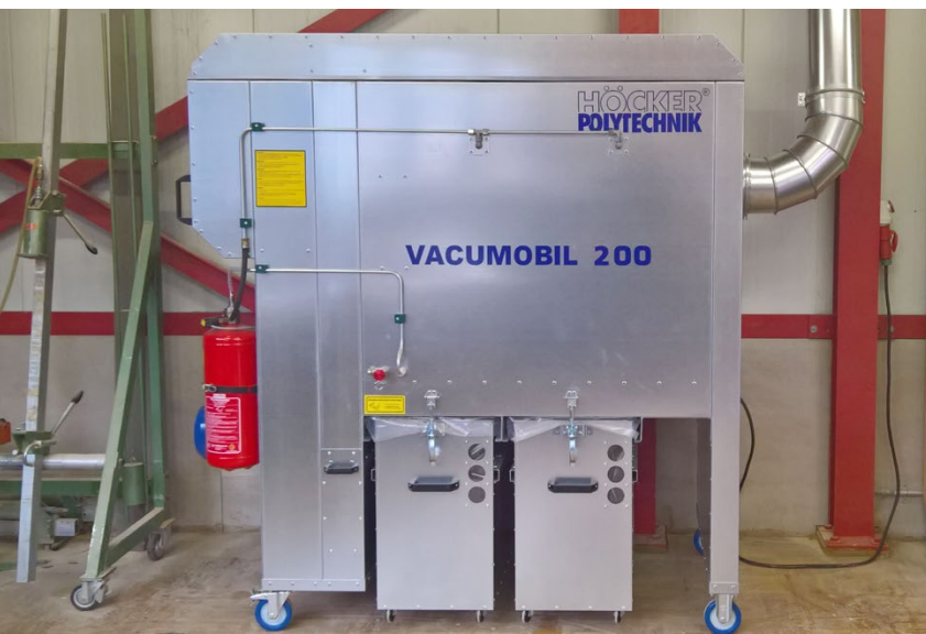
Abb. unten: Vacumobil VT 200 mit Brandunterdrückungssystem (optional)
