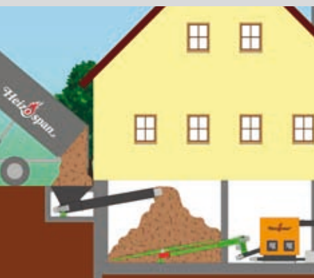
Indrukvijzel voor brandstofopslagplaatsen binnen het gebouw.
