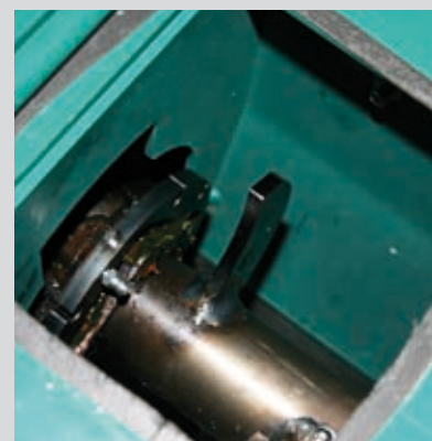
Uitvoerkop met splijthaak.
