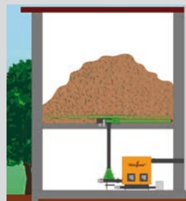
Bovenhoofdse uitvoer voor spaanbunkers.
