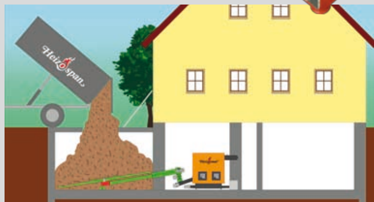
Ondergrondse bunker, eenvoudig te vullen met een landbouwapparaat.
