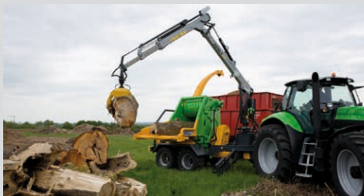
Heizohack houthakmachine met kraantoevoer voor 50 - 80 cm stamdoorsnede.
