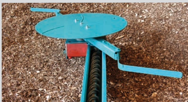
Robuuste scharnierarmuitvoer van 1 - 7 m, voor een betrouwbaar transport van de brandstof.
