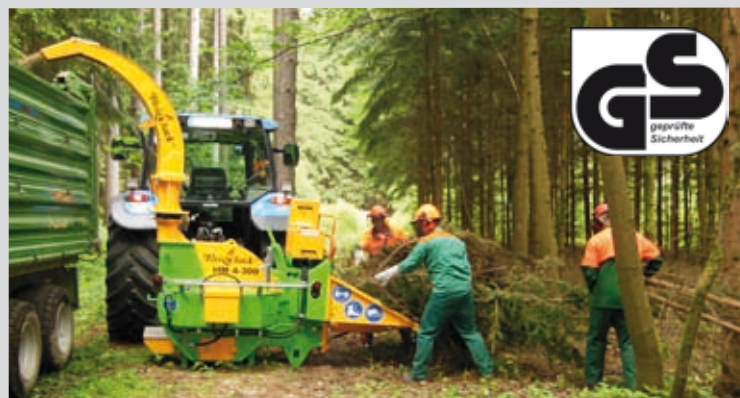
Heizohack houthakmachine met handtoevoer voor 30 - 40 cm stamdoorsnede.
