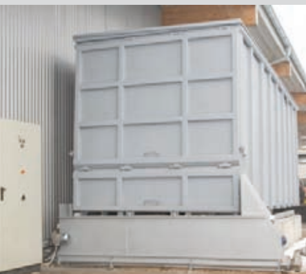
HeizoCont wisselcontainer met schuifbodem.
