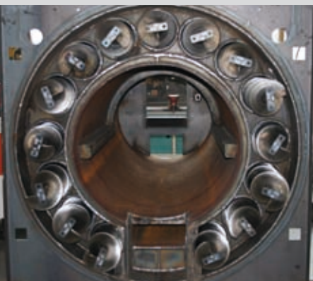
Royale rookkanalen met reinigingsvijzels.
