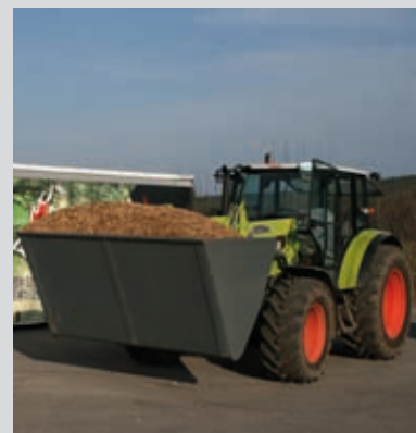
Heizoschaufel schepbak voor houtsnipper.
