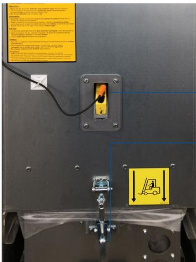
Die Laserlichtschranke überwacht die Füllhöhe der Staubsammeltonne
